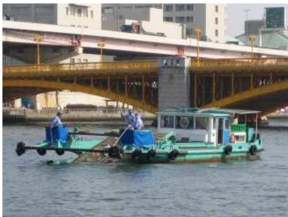
図 3.3 隅田川の小型ゴミ回収船 (出典：東京都第一建設事務所 HP)
