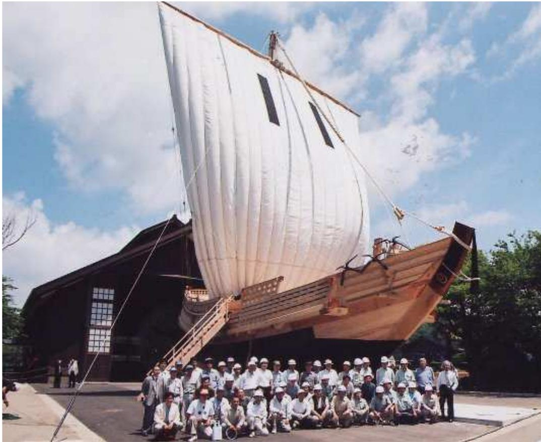
図 1-2 白山丸 512 石積（約 77 t）、全長 23.75m、最大幅 7.24m、艫高 6.61m
