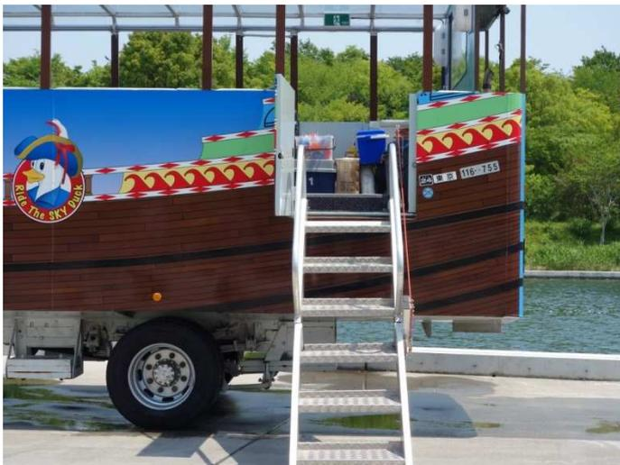
後部の乗り込み階段、車体下部にプロペラ先端が見える。これらからプロペラはかなり上にある。船側底部と最後部底部に鋼板性の固定バラストが見える。
