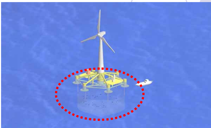
セミサブ式浮体の下部空間に養殖いけすを設置
