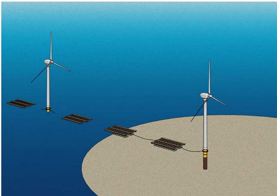
着床式洋上風車の基礎を利用して貝類の養殖を行うイメージ
